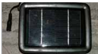
La placa fotovoltaica capta la llum solar i l'emmagatzema a la bateria
