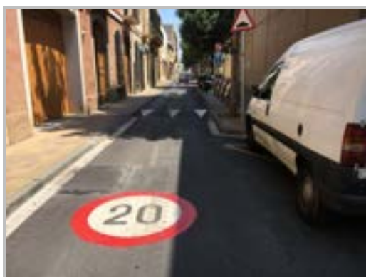
Imatge 8. Senyalització horitzontal de 20 km/h amb ressalt al carrer Santa Isabel. Font: AIM, elaboració pròpia.
